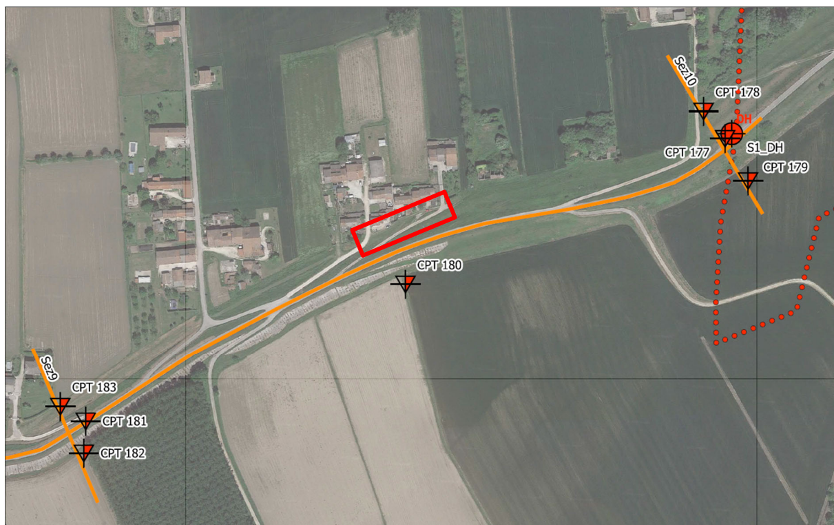
Figura 3 - Planimetria di ubicazione delle indagini geotecniche svolte. Il rettangolo rosso indica l'area di installazione dei gabbioni metallici.
